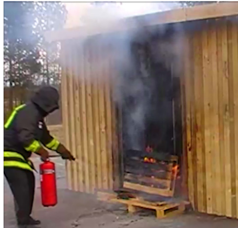
FSI-Gel släckte branden helt på 5 sekunder. Åtgång 1 liter.
